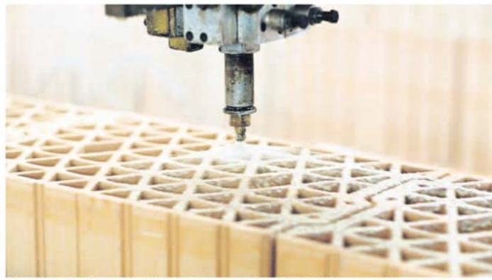
Leim wird auf einen Ziegel aufgespritzt. Dank dieser Technik können ganze Wandmodule bereits im Werk vorgefertigt werden
